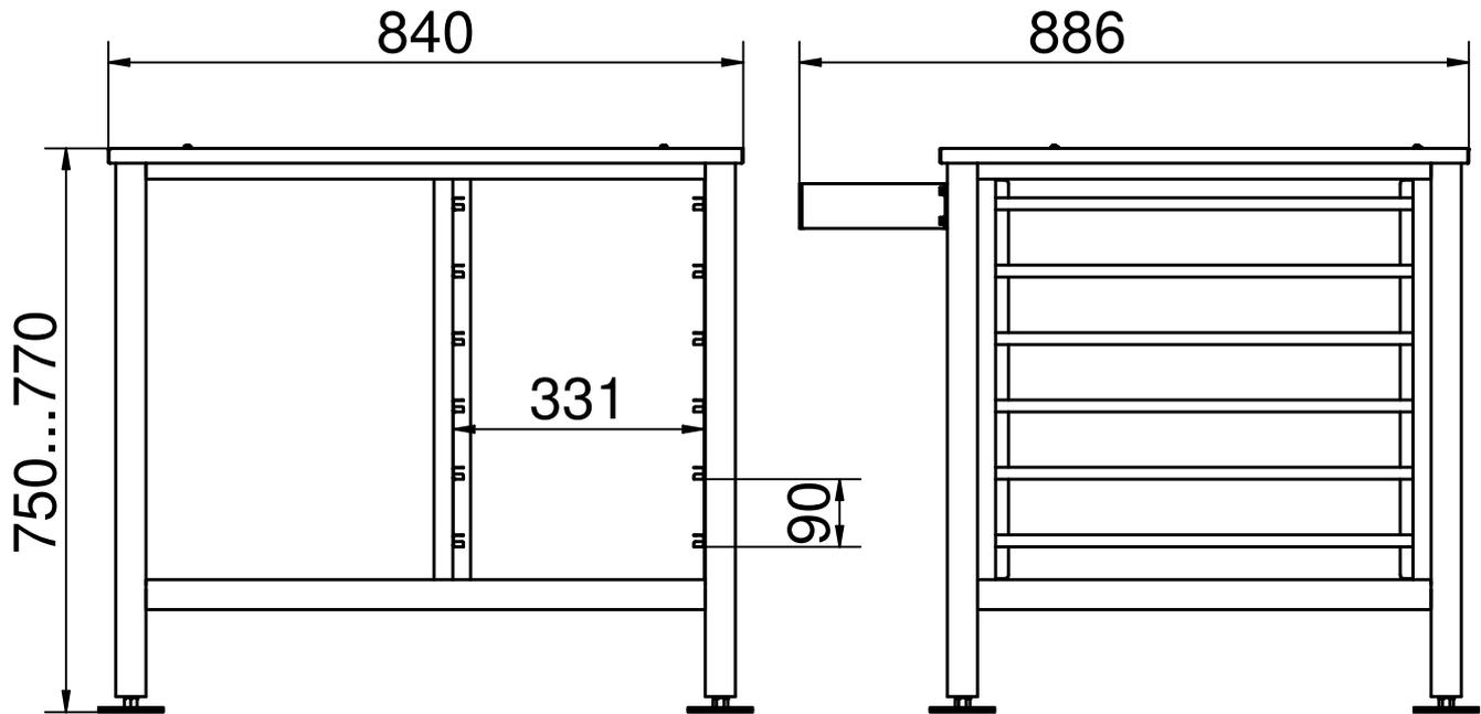
Подставка ПК-6МФ является вспомогательным оборудованием и предназначена для установки пароконвектомата типа ПКА6-1/1ПМФ на столешницу и размещения шести gastronormов GN 1/1 на держателях полок.
